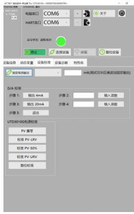
5、点设备校准，再将介质置零位置、50%位置、满度位置分别点击“校准PV-LRU”“校准PV-50%”“校准PV-URV”。
